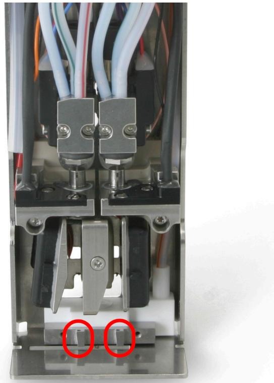
10. Ako je vrednost *Vacuum pressure (mbar)* (Vakumski pritisak (mbar)) manja od -180, pređite na sledeći korak. Ako je vrednost *Vacuum pressure (mbar)* (Vakumski pritisak (mbar)) i dalje veća od -180, dodajte malu količinu rastvarača u blokiranu cev za odvod i sačekajte da se stabilizuje vrednost *Gutter pump speed (rpm)* (Brzina pumpe za odvod (o/min)).
