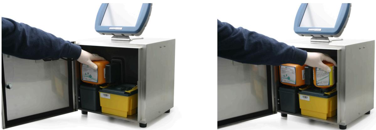
4. Okrenite kertridž sa mastilom u smeru kazaljke na satu, a kertridž sa razređivačem u suprotnom smeru, pazeći da poruka bude okrenuta prema vama.
