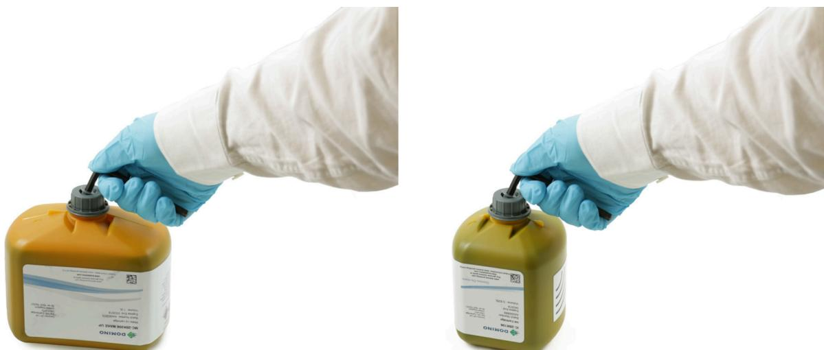
3. Gurnite kertridž sa razređivačem u razvodnik modula razređivača, a kertridž sa mastilom u ITM.
