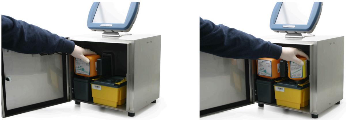
6. Okrenite kertridž sa mastilom u smeru kretanja kazaljke na satu, a kertridž sa razređivačem u suprotnom smeru. Pazite da oznaka bude okrenuta prema vama.
